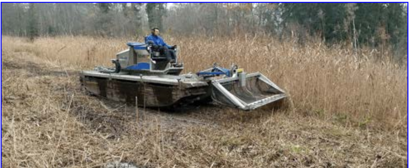
Abb. 31: Schilfmahd im Hangquellmoor „Federmäher“ mit dem besonders bodenschonenden „Truxor“.
