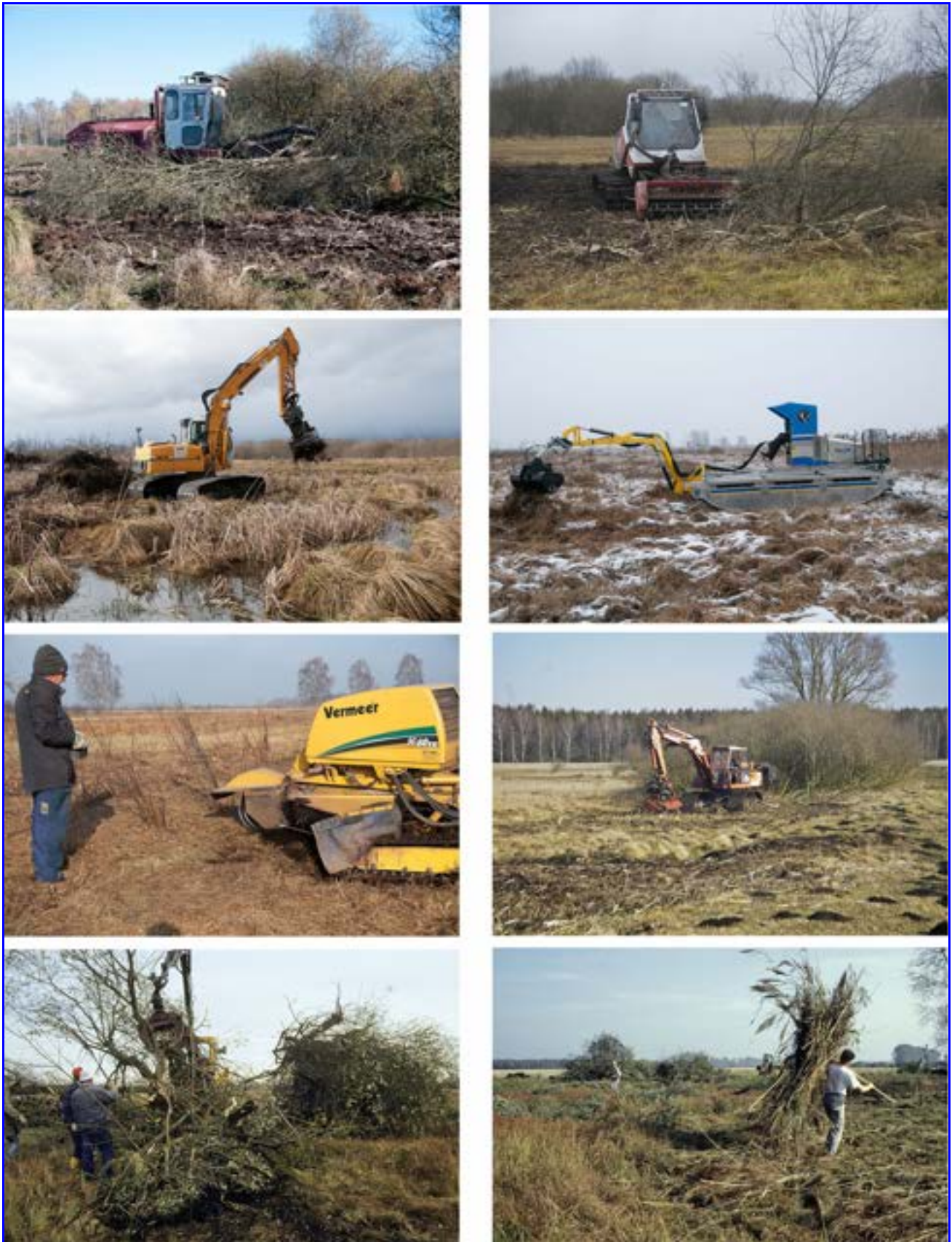
Abb. 8: Entbuschungstechniken: verschiedene Fräsen, Bagger, Seilwinde und immer wieder Handarbeit.
