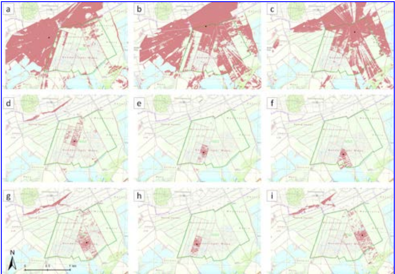
Abb. 78: Sichtbarkeitsanalyse basierend auf einem digitalem Geländemodell: Schwarze Punkte symbolisieren einen dort befindlichen Brachvogel mit einer Sichthöhe von 30 cm. Die rot markierten Flächen stellen das Sichtfeld der jeweiligen Punkte dar. (a-c) Im Randbereich haben die befestigten Wege keinen Einfluss auf das Sichtfeld. (d-i) Das Wegenetz verursacht aber eine deutliche Kammerung oder Fragmentierung des Kerngebietes, da es dort ausgeprägte Sichtbarrieren bildet (aus Rehm & Mäck 2020).
