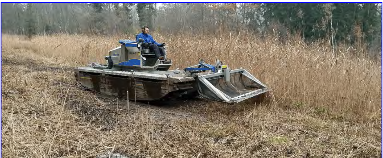
Abb. 37: Schilfmahd im Hangquellmoor „Federmäher“ mit dem besonders bodenschonenden „Truxor“.
