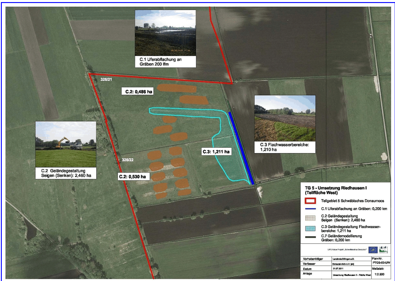
Abb. 68: Umsetzungsbeispiel „Riedhausen-West“: Grabenabflachung und -erweiterung mit Flachmulden im landwirtschaftlich genutzten Grünland.
